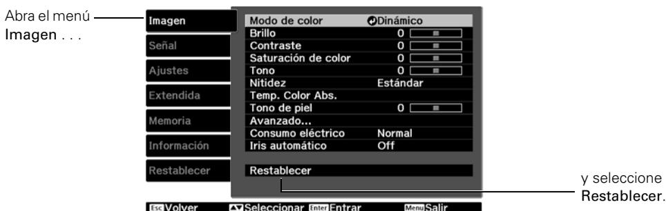
Puede reiniciar el temporizador de uso de la lámpara o restablecer todos los ajustes del proyector a sus valores originales. Siga estos pasos:
