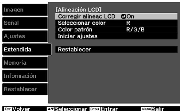
2. Configure el ajuste **Corregir alineac LCD** en **On**.
